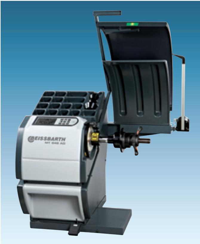
MT 848 AD ist eine Neuentwicklung von Beissbarth für OEM Kunden die in nur 6 Sekunden ein komfortables und schnelles Wuchten der Räder von PKWs, Motorrädern und Transportern ermöglicht. Die Bedienung erfolgt über eine Folientastatur zur Dateneingabe und Funktionssteuerung. Die Anzeige der Gewichtgröße erfolgt über das robuste Doppel-LED-Display. LED-Einweis Pfeile zeigen die Ausgleichspositionen an.
