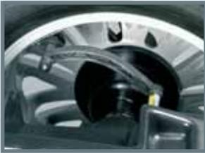
Di serie su microtec 845.AD/865.AD: braccio dati elettronico easyfix® per applicare con precisione pesi adesivi nascosti.
