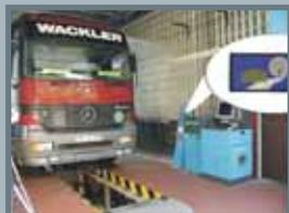
Misuratore di percorso/tachigrafo TC-Net per la prova dal posto di guida mediante trasduttore induttivo con display.
