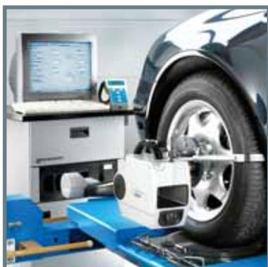
Accessori speciali per microline 81 tech/5001: misuratore d'inclinazione per il livello del veicolo; i dati confluiscono nell'assetto delle ruote.
