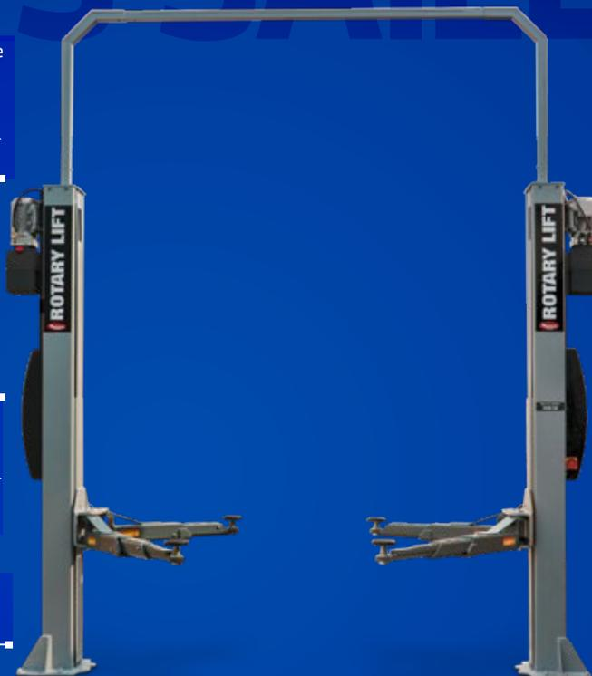
Deux vérins hydrauliques verticaux transmettent la puissance via des chaînes de charge redirigées, de sorte qu'aucun vérin ne fonctionne ou ne dépasse la colonne, permettant ainsi une hauteur d'installation minimale de 2908 mm
